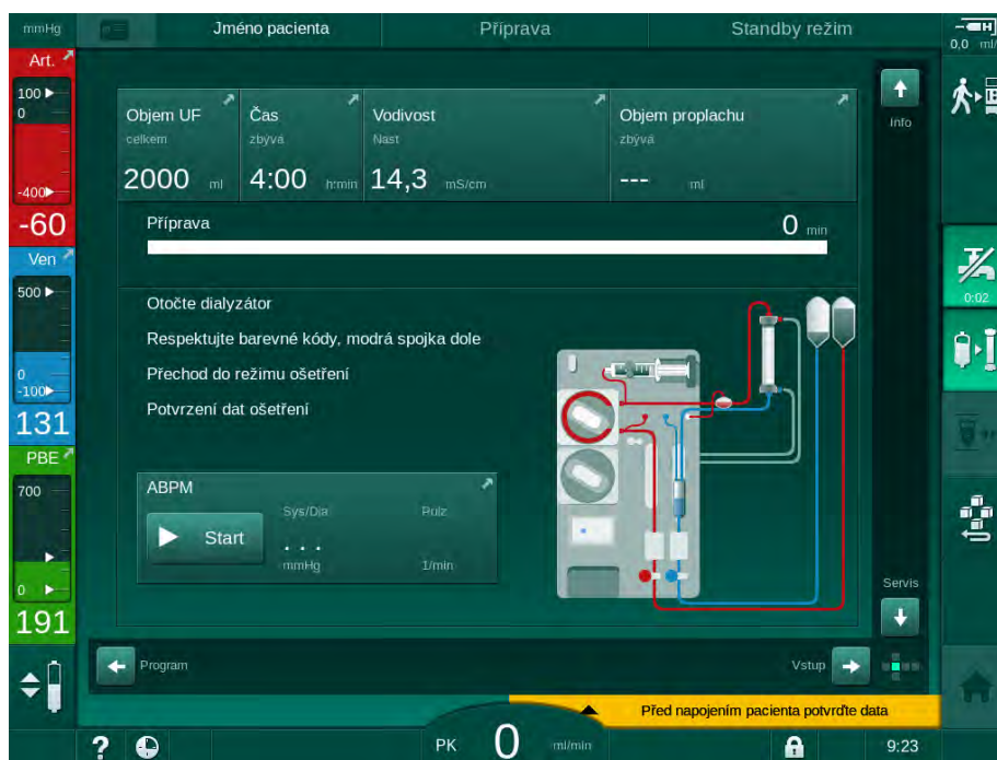
Obr. 5-5 Automatické testy a proplach jsou dokončeny
