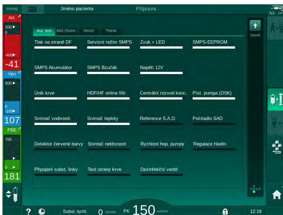
Obr. 5-3 Stav automatického testu na obrazovce Servis
