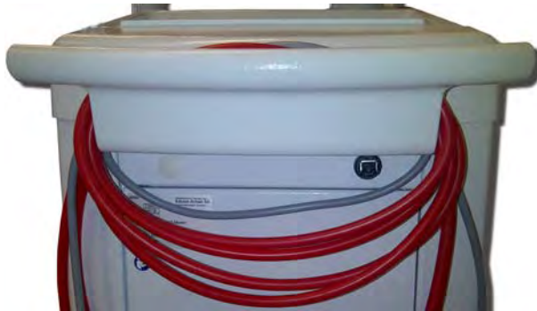
Obr. 4-1 Uložení kabelů a hadic
