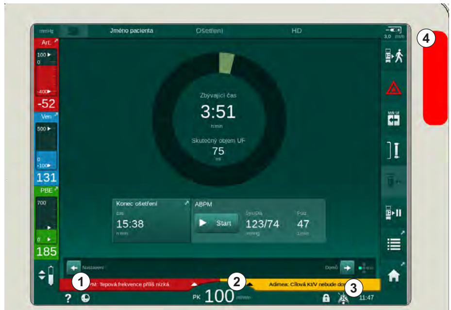
Obr. 12-1 Pole alarmů a varování a signalizační světlo
