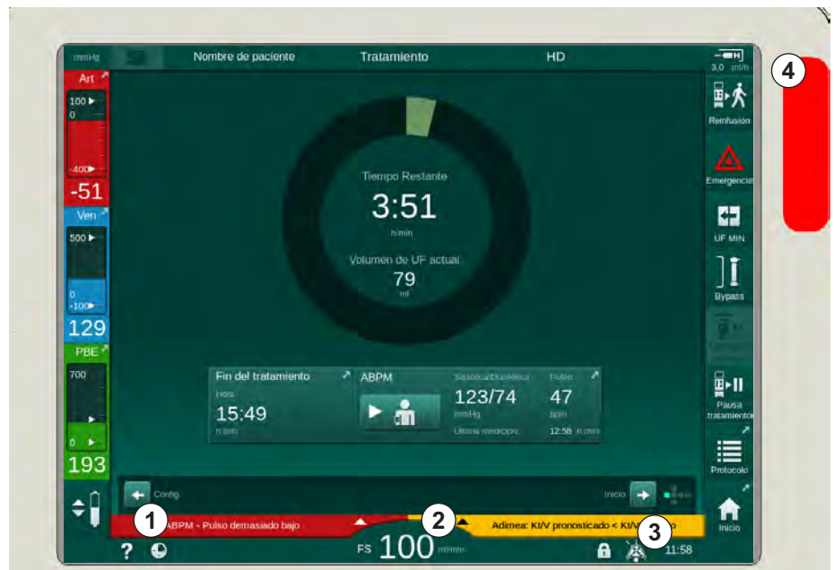
Fig. 12-1 Campos de alarmas y advertencias e indicador luminoso
