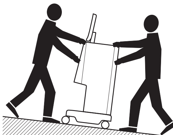
Fig. 4-2 Transporte del equipo por escaleras y en pendientes (2 personas)
