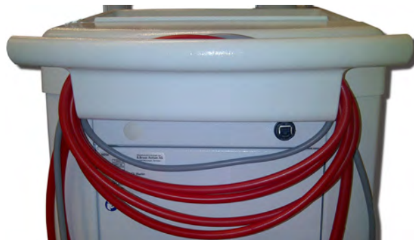
Fig. 4-1 Almacenamiento de cables y tubos
