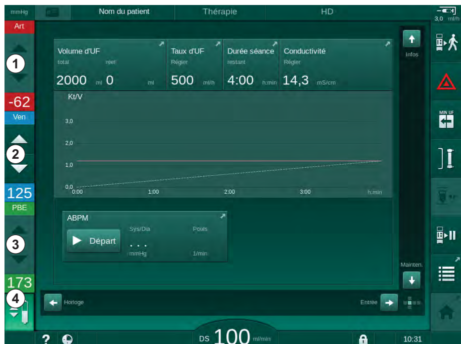
Fig. 6-4 Régulation des niveaux en traitement
