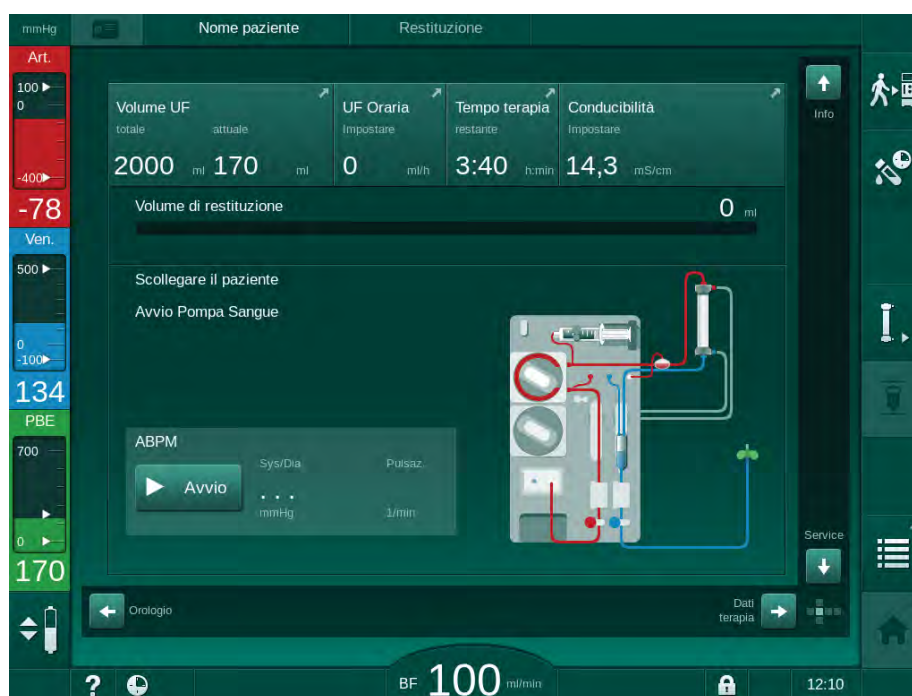
Fig. 6-19 Videata restituzione - preparazione della restituzione
