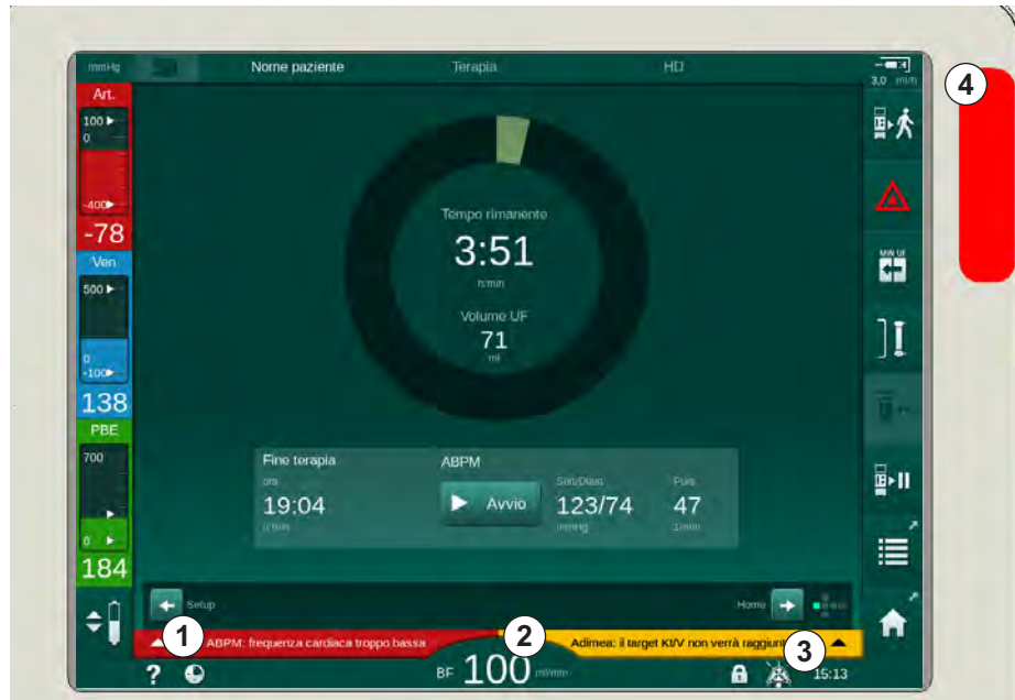
Fig. 3-13 Campi di allarme e avvertenza
