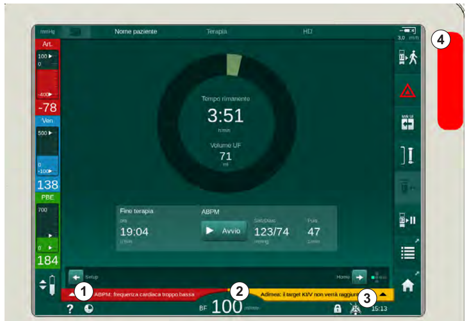
Fig. 12-1 Campi di allarme e avvertenza e lampade luminose
