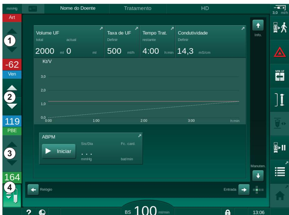
Fig. 6-4 Ajuste de nível no tratamento
