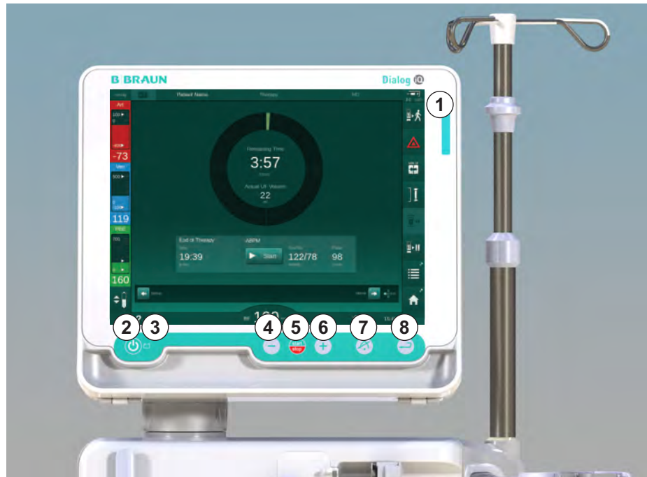
Zobr. 3-10 Monitor s ovládacími prvkami a indikátormi
