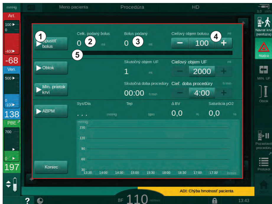
Zobr. 6-8 Spustiť bolus na obrazovke Núdzový prípad
