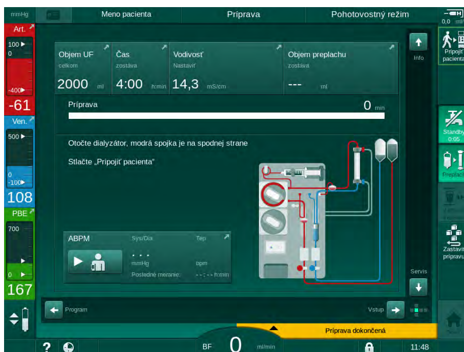
Zobr. 5-5 Automatické testy a preplach sú dokončené
