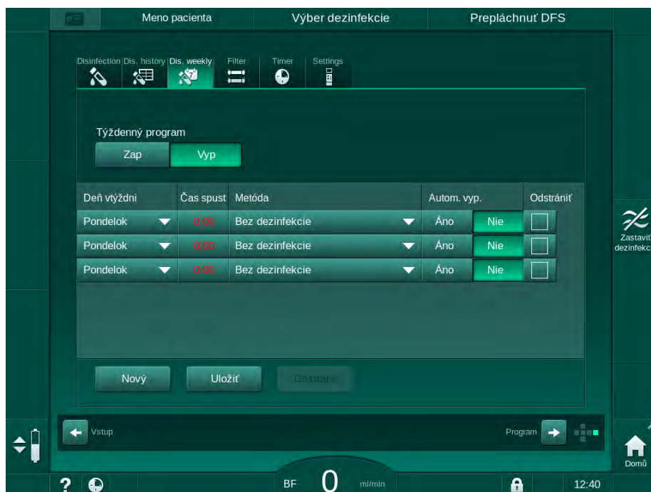
Zobr. 7-18 Týždenný dezinfekčný program na obrazovke Nastavenie
