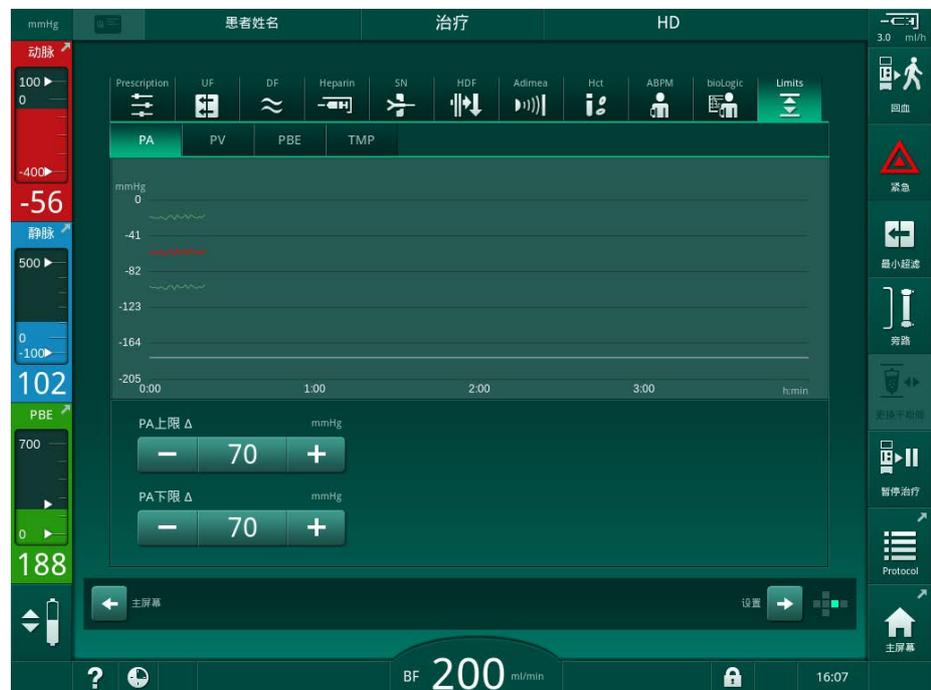
图. 5-21 输入屏幕上的压力限值示例
