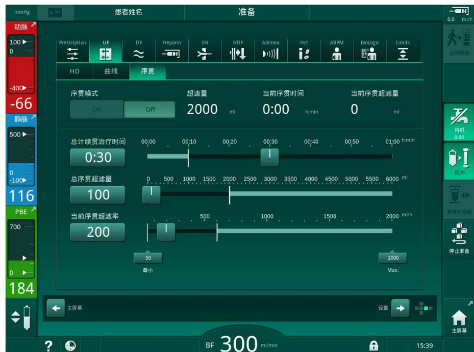
图. 5-16 序贯超滤参数
