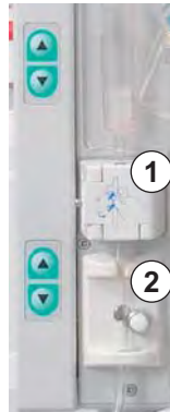
Abb. 5-11 Einlegen der venösen Leitung
