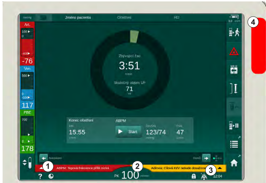
Obr. 3-13 Pole alarmů a varování
