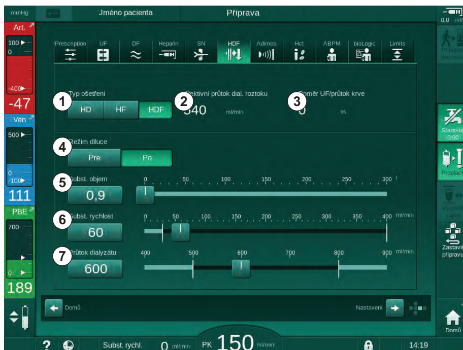
Obr. 8-2 Parametry HDF/HF Online na obrazovce Vstup
