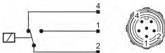
Obr. 11-44 Konektor zařízení pro přivolání personálu
