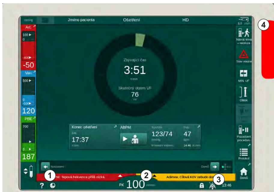
Obr. 3-13 Pole alarmů a varování
