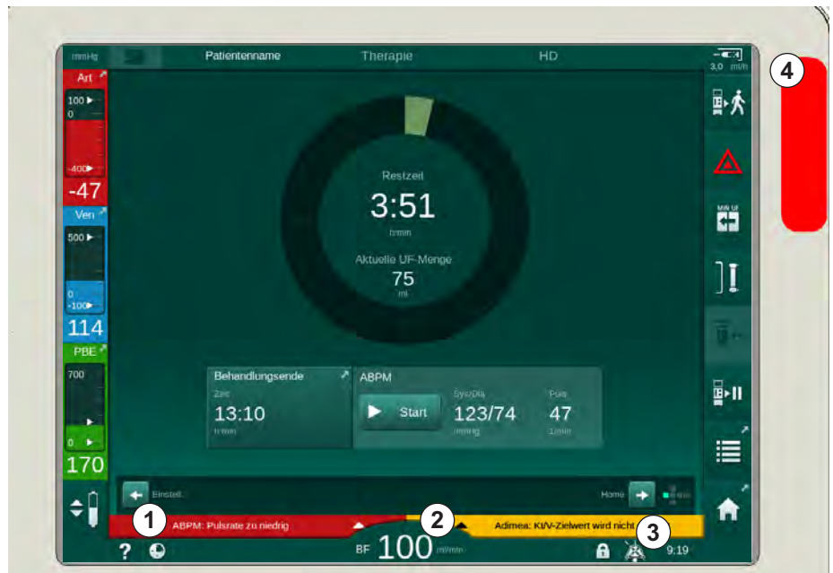
Abb. 12-1 Alarm- und Warnfelder und Signalleuchte
