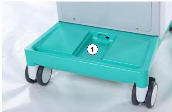
Abb. 7-19 Vertiefung mit Lecksensor
