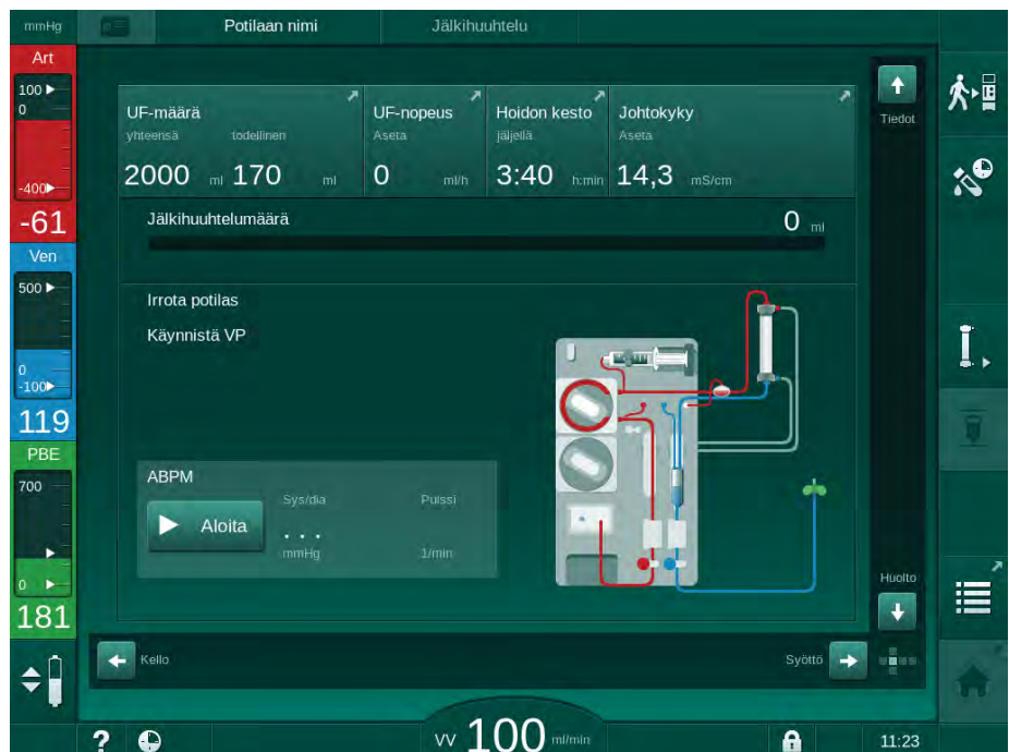
Kuva. 6-19 Jälkihuuhtelu-näyttö - jälkihuuhtelun valmistelu
