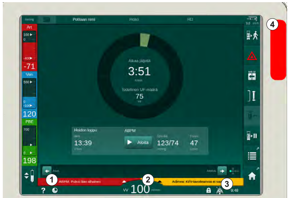
Kuva. 12-1 Hälytys- ja varoituskentät ja merkkivalo
