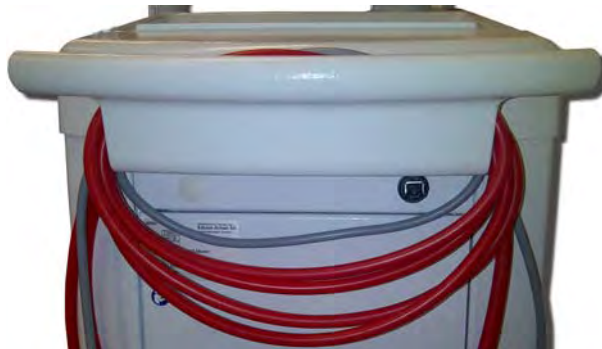
Slika. 4-1 Pohranjivanje kabela i cijevi
