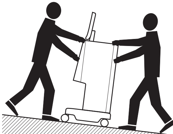
Ábra 4-2 A készülék mozgatása lépcsőn és lejtőkön (2 személy)
