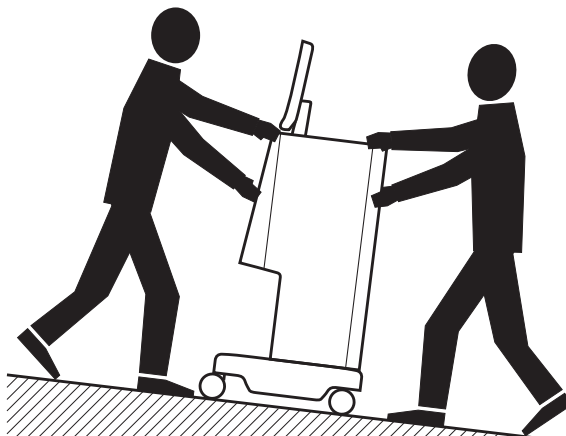
Iliustracija 4-2 Aparato transportavimas laiptais ir pakylomis (2 asmenys)
