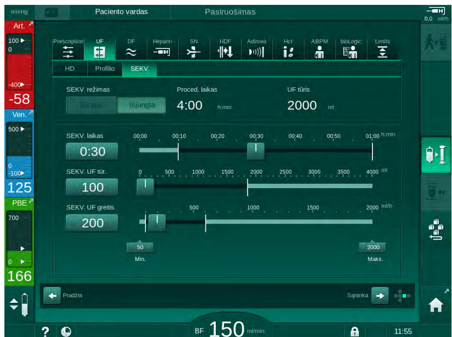
Ilustracija 5-16 Sekvencinės ultrafiltracijos parametrai
