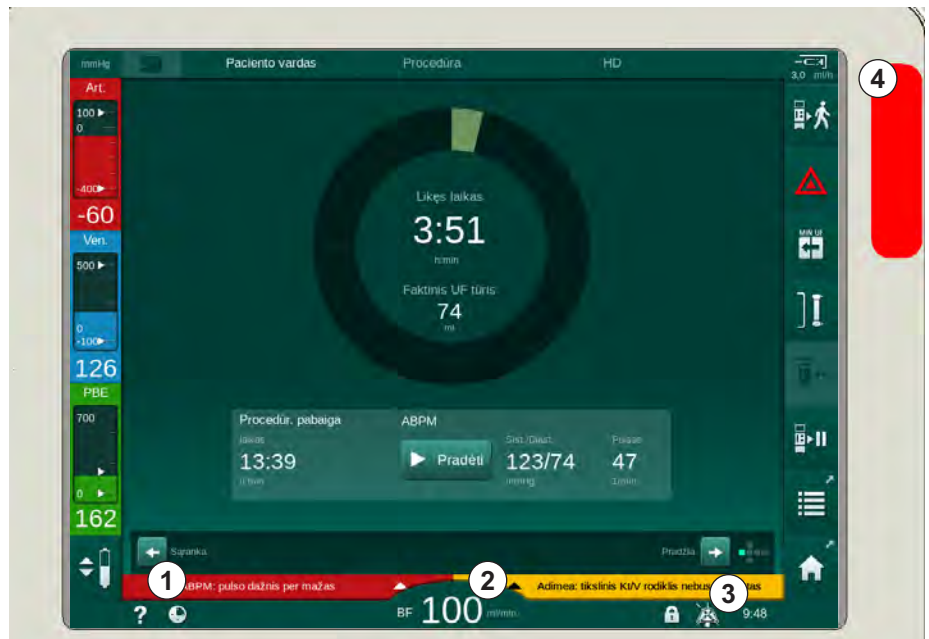
Ilustracija 12-1 Aliarmų ir įspėjimų laukeliai ir signalinė lemputė
