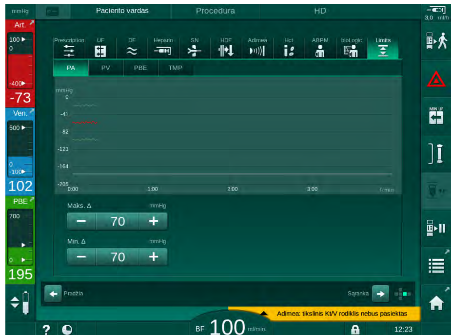
Ilustracija 5-20 Įvesties ekrane rodomų slėgio ribų pavyzdys
