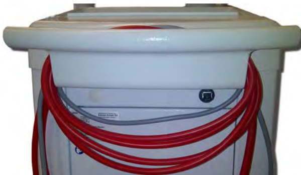
Afb. 4-1 Opbergen van kabels en slangen
