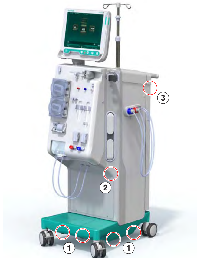
Afb. 4-3 Vasthoudpunten om de machine te dragen
