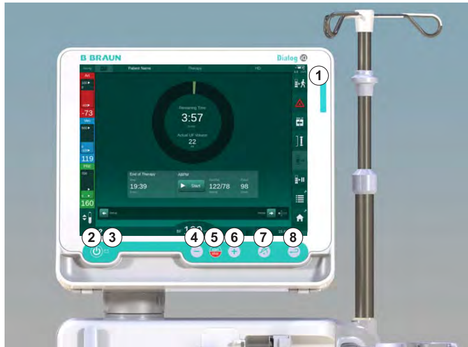
Bild 3-10 Monitor med reglage och indikatorer
