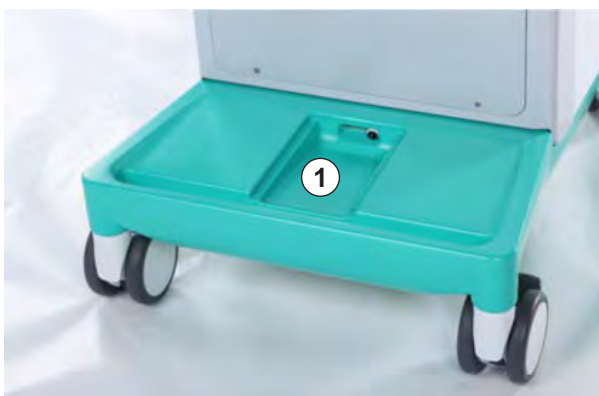
Bild 7-19 Fördjupning med läckagesensor
