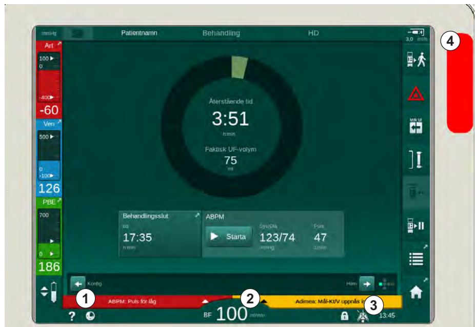
Bild 3-13 Larm- och varningsfält
