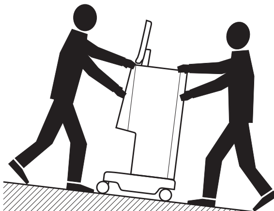
Bild 4-2 Flytta maskinen i trappor och lutningar (2 personer)
