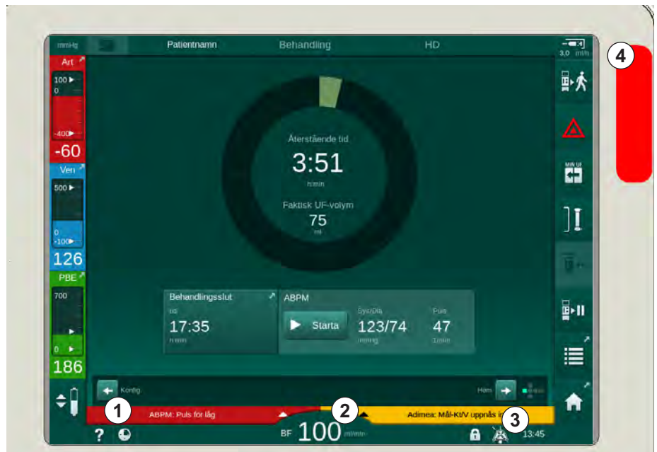
Bild 12-1 Larm- och varningsfält och signallampa
