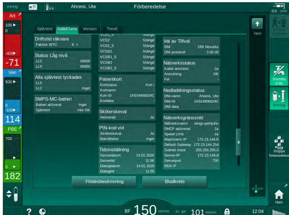
Bild 11-29 DNI-data på skärmen Service
