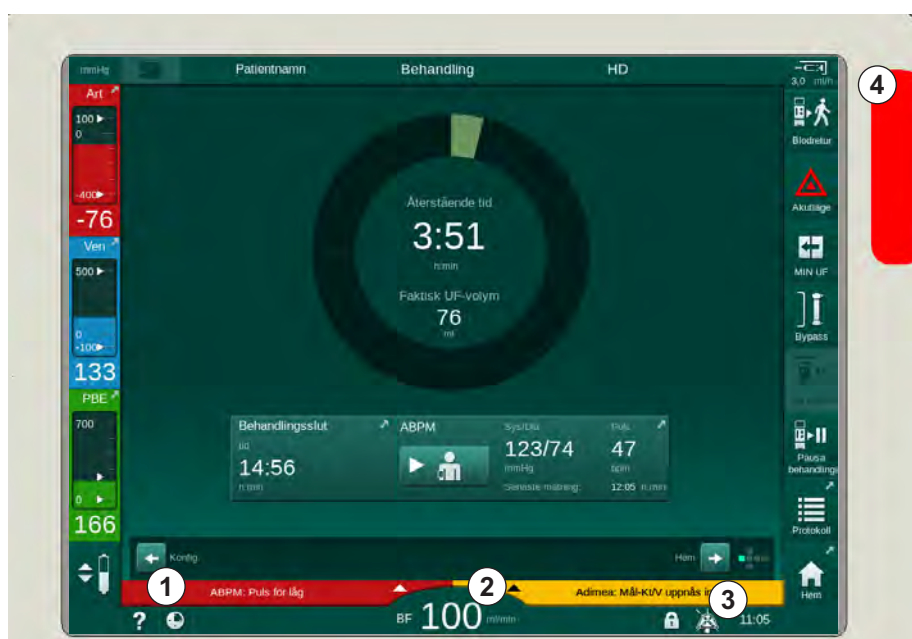
Bild 12-1 Larm- och varningsfält och signallampa
