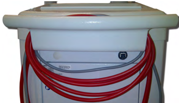
Bild 4-1 Förvaring av kablar och slangar
