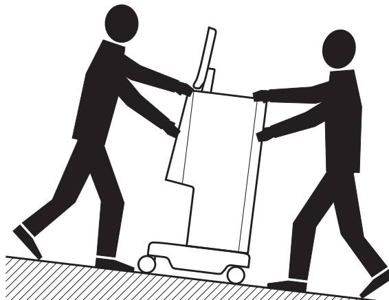
Bild 4-2 Flytta maskinen i trappor och lutningar (2 personer)
