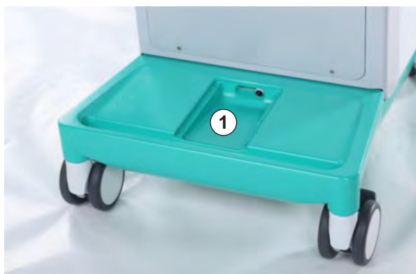
Bild 7-20 Fördjupning med läckagesensor
