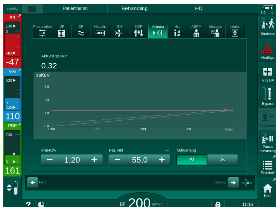
Bild 11-13 Grafisk presentation av dialysens effektivitet
